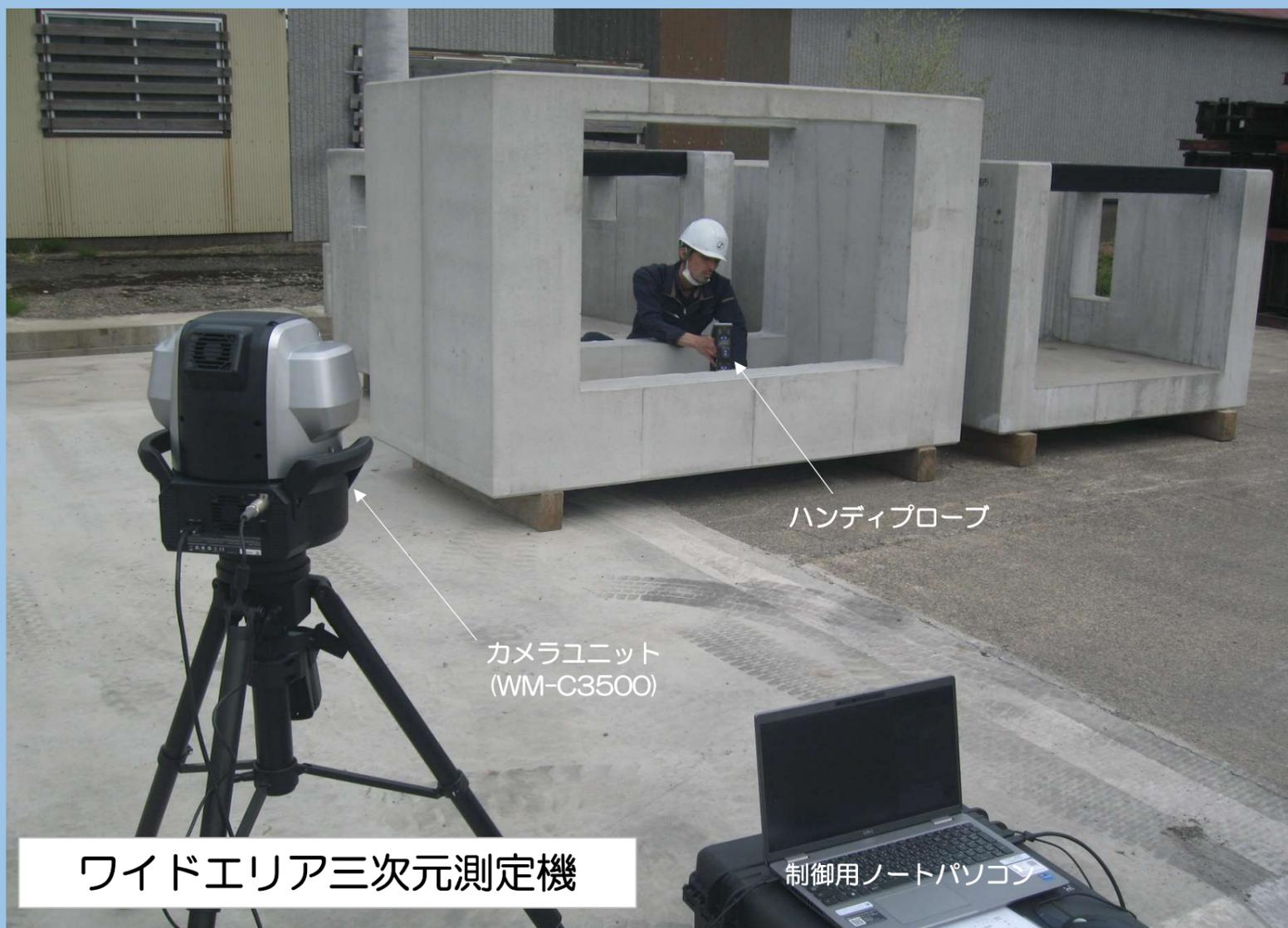
※カメラユニットを三脚にセットして、ノートパソコンとケーブルで繋がれば設置完了
